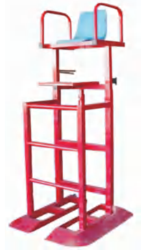
SC-88109 排球裁判椅 Volleyball referee chair 立柱60x60x2.5mm的优质钢管，升降高度2200mm，占地面积800x1000mm，底座3mm的优质钢板折弯焊接成型。 建议零售价：¥9000/pc
