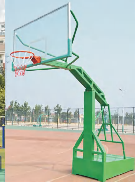
SC-88355 豪华大箱篮球架 Imitation hydraulic basketball stand 底箱尺寸: 190x100cm 钢板厚度2mm, 箱体放置配重600KG/付 立柱尺寸: 10 X 26cm方管 高186cm 篮球架伸臂1900mm, 伸臂颜色为白色, 篮球框上沿离地面3050mm. QTY:1pair=12pkgs G.W:550kgs/pair CBM : 4/pair 建议零售价: ¥29000/pair
